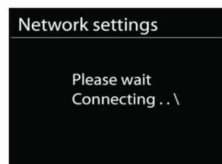
Jakmile úspěšně proběhne nastavení, zobrazí se připojení. Pokud se připojení nezdaří, ICD4350 se vrátí na předchozí obrazovku a zkusí to znovu.
