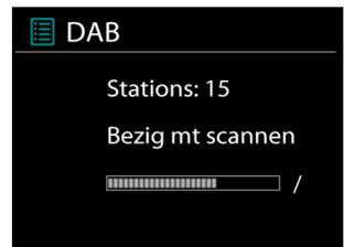
Kies Volledige scan om een scan uit te voeren. Zodra de scan voltooid is, toont de radio een lijst met beschikbare zenders.
