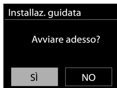
**Nota:** se la configurazione guidata viene annullata prematuramente senza una configurazione di rete, il dispositivo genera il proprio accesso WiFi in modo che il dispositivo possa essere configurato tramite l'APP UNDOK.
