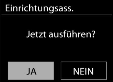
**Hinweis:** Wird der Einrichtungsassistent ohne Netzwerkeinrichtung vorzeitig abgebrochen, wird vom Gerät ein eigener Wifi Zugang generiert, damit das Gerät über die UNDOK-APP konfiguriert werden kann.
