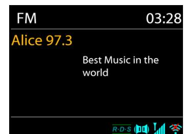
Im UKW-Radiomodus werden analoge Radiosender über das UKW-Band empfangen und RDS-Daten (Radio Data System) Zusatzinformationen bzgl. des Sender angezeigt.
