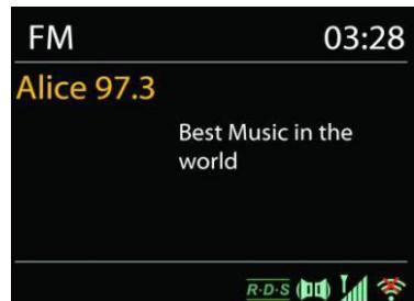
Pro ruční vyhledávání stiskněte a podržte tlačítko „◀“ nebo tlačítko „▶“ na panelu nebo tlačítka dálkového ovladače „P+“ nebo „P-“. Spustí se zobrazení frekvence a prohledává se pásmo FM, přičemž se zastaví na další stanici.
