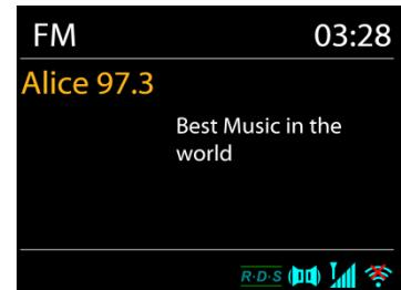
De FM-radiomodus ontvangt analoge radio vanuit de FM-band en toont RDS (Radio Data System)-informatie over de zender en waar er wordt uitgezonden.
