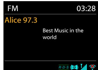
En mode radio FM, l'appareil reçoit la radio analogique depuis la bande FM et affiche les informations RDS (Système de données radio) à propos de la station et des diffusions.
